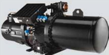
**IT** L'uso dei compressori a vite garantisce assenza di vibrazioni, bassi spunti in avviamento grazie all'avviamento part-winding o stella-triangolo. La protezione ai ritorni di liquido è garantita mediante il procedimento di pump-down.
