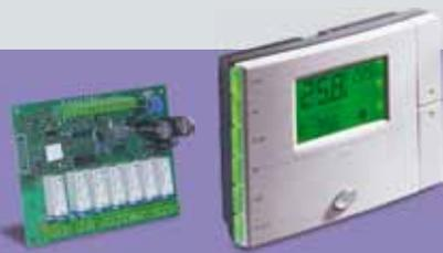
☒ Aria è un controllore elettronico di facile utilizzo ed impiego, è organizzato in due sistemi integrati: un terminale da porre in ambiente e una scheda di potenza per la gestione degli attuatori.
